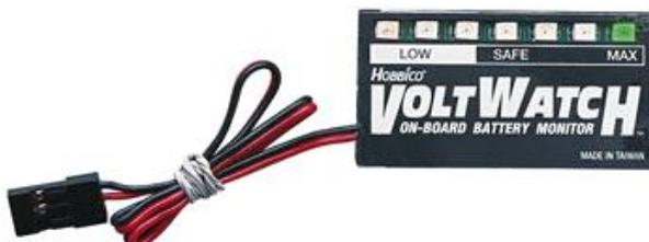
Exemplo de um “VoltWatch” para baterias LiPo.
