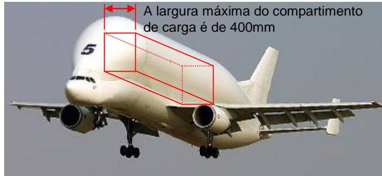
Essa largura será tomada pela distância entre os pontos mais a esquerda e mais à direita com relação à aeronave. Em outras palavras, independente da posição e alinhamento do paralelepípedo que forma o compartimento de carga, sempre será medido entre os extremos. A figura abaixo ilustra esta medida:
